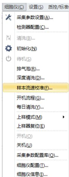
3 选择需要校准的取样速度，并选择校准。显示“校准样本流速”窗口。
