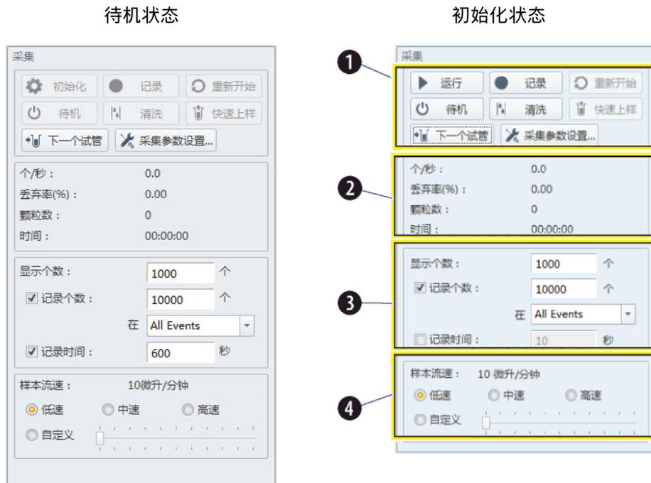
1. 采集控制。控制样本加载/卸载以及数据采集和记录。
