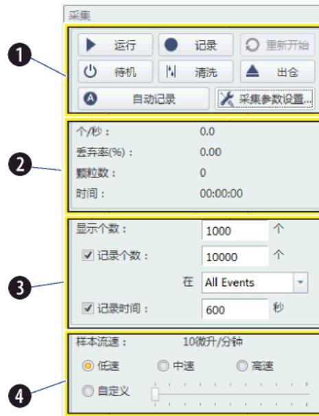
1. 采集控制。控制样本加载/卸载以及数据采集和记录。
