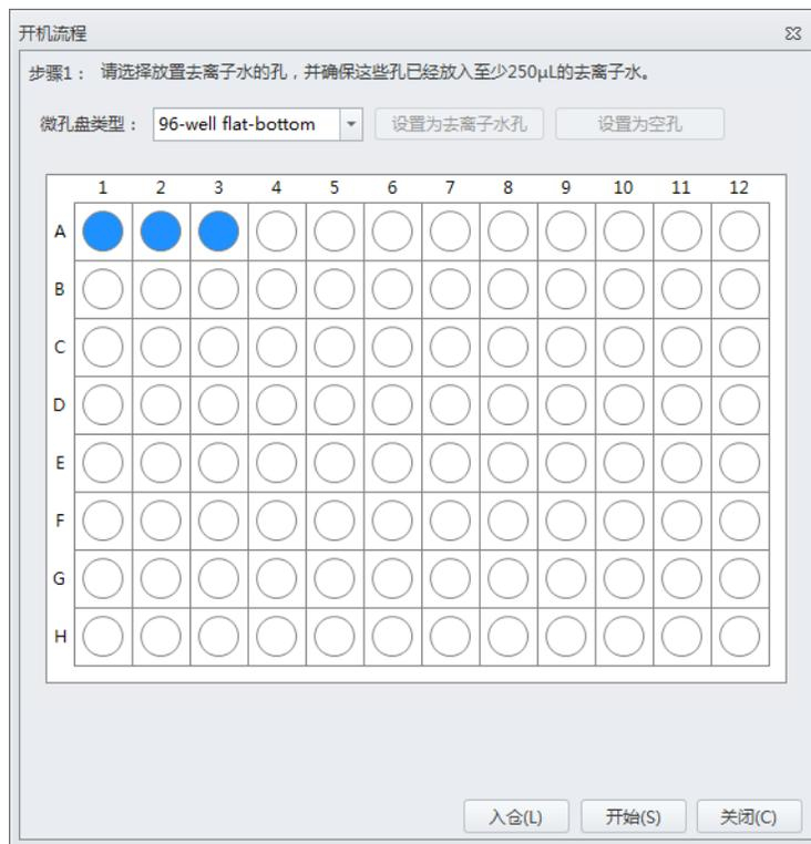
3 循屏幕上的软件提示，选择所需的孔并设置为去离子水孔。
