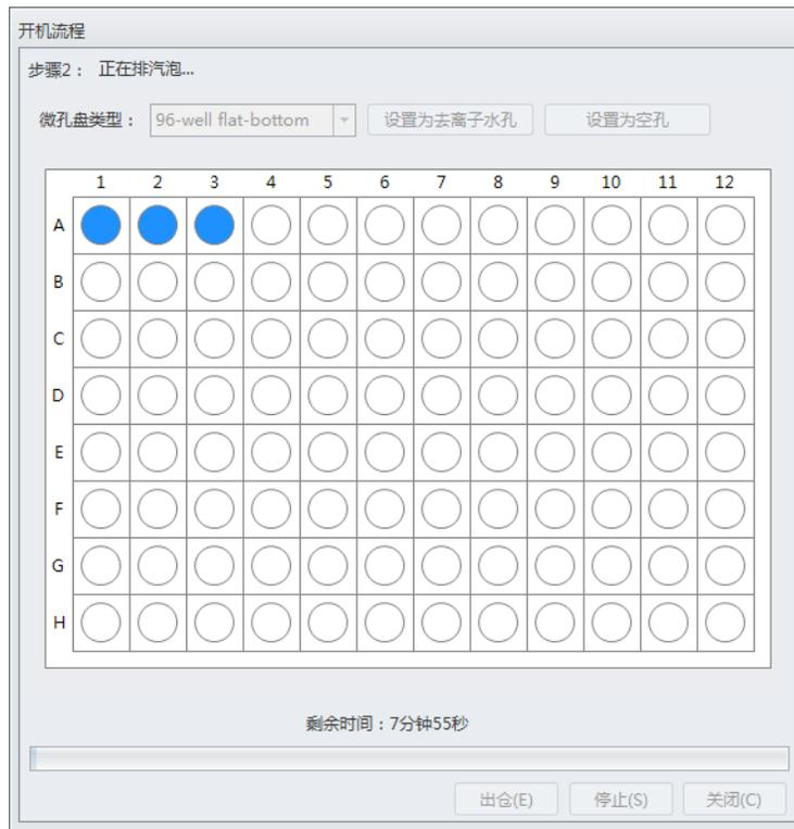
排气泡后，系统再次进行初始化。样本自动加载。对于每个孔，该过程大约需要 1 分钟。
